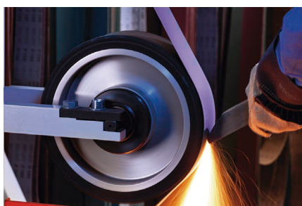
Rebarbamento de aço | Remoção do ponto de injeção
