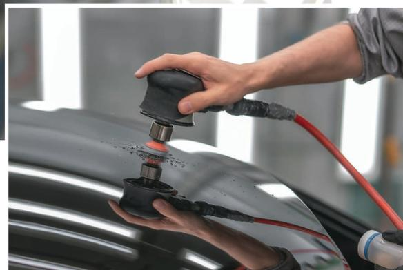
El grano estructurado de forma piramidal garantiza un proceso de desgaste lento y constante.
