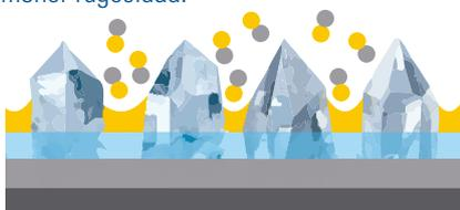
El sistema antiadherente (en amarillo) liga el polvo de lijado. El rendimiento se alarga notablemente.
