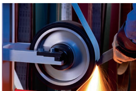
Desbarbado de acero
