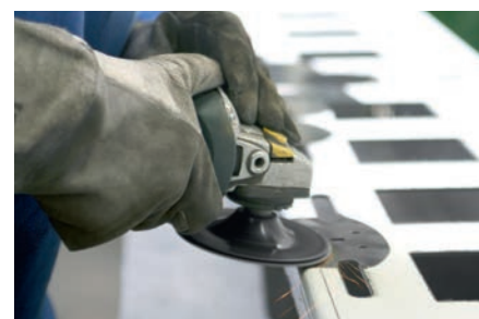
Repaso de chapas y juntas de soldadura
