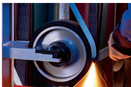
Desbarbado de acero
