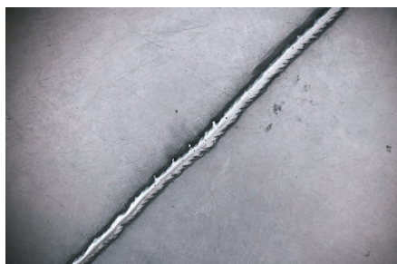
Juntas de soldadura y lijado de rebabas
