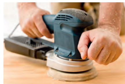
Lijado orbital de planchas de madera y de muebles
