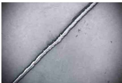
Fabrico de recipientes | Nivelamento de cordão de solda
