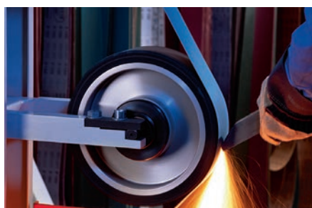
Rebarbamento de aço
